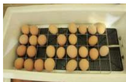
Рисунок 4. Ставим металлическую решетку. Подцепляем к устройству автоматического переворачивания яиц. Помещаем яйца в инкубатор.
