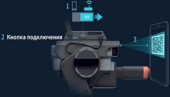
3. Управление RoboMaster S1. Все изображения с камеры, точнее все, что “видит” робот, передаются на дисплей вашего ПК. Качество изображения стабильное. Формат изображений 720p при частоте 30 кадрах в секунду. В целом, это вполне позволяет адекватно видеть ситуацию перед и вокруг робота – танка и ориентироваться во время игры. Управление RoboMaster S1 выполняется с помощью клавиш W, A, S и D и вращаете его с помощью мыши.
